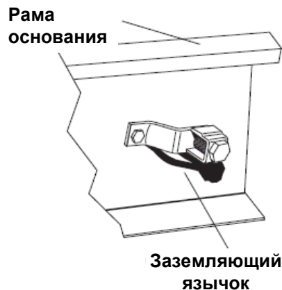
Рисунок 2.2. Заземляющий язычок генератора (типовой)
