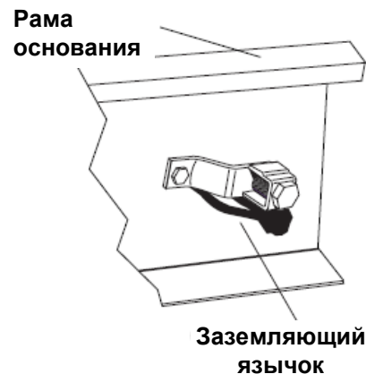
Рисунок 2.2. Заземляющий язычок генератора (типовой)
